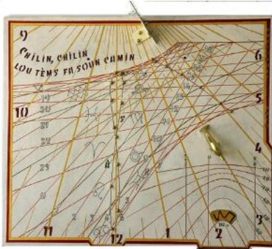
Cadran de Jean Pakhomoff à heures solaires et sidérales, incluant une courbe donnant le moment de la prière de l'Asr et indiquant également la hauteur et l'azimut du Soleil.
