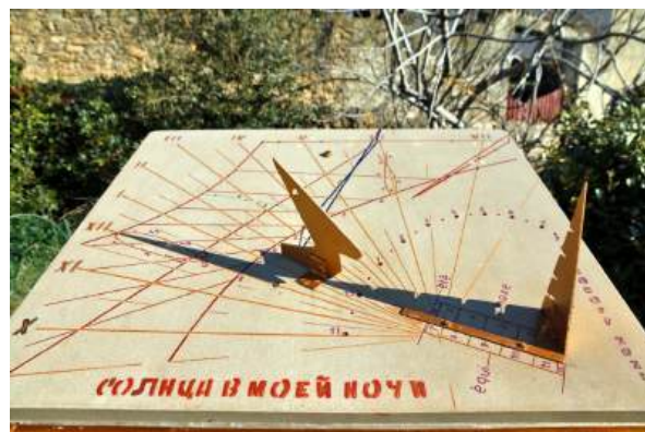
Cadran déclinant sud-ouest sur un plan incliné avec analemmatique réalisé en 2021.
