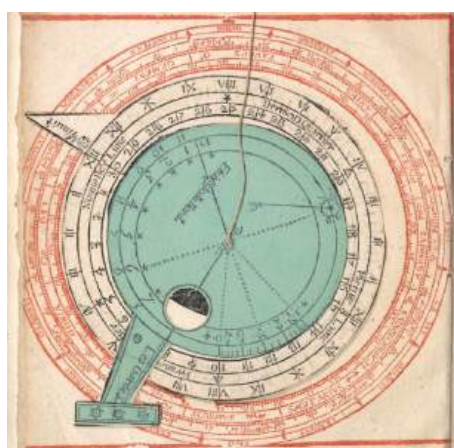
Fig.2. Le nocturlabe et le cadran solaire de hauteur. Le cercle noir et blanc est une fenêtre donnant l'aspect de la Lune au fil des jours.
