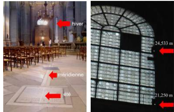
Figure 3 : la méridienne et ses extrema. En hiver, elle se prolonge sur l'obélisque placé au transept nord. Deux œilletons sont encore visibles sur le vitrail du transept sud.
