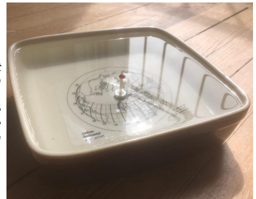
Fig.5 - Un récipient contenant 4,5 cm de hauteur d'eau. Le tracé a été collé au fond, et un style vertical perce la surface de l'eau.
