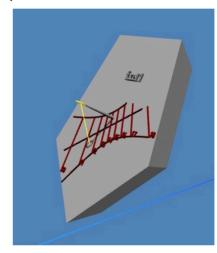
Le logiciel doit pouvoir tracer un cadran solaire sur chaque face du polyèdre, sans déborder sur les autres faces. Chaque face est modélisée par une pyramide tronquée dont le sommet est le centre de symétrie du polyèdre.
