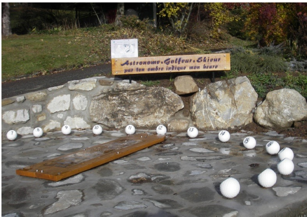
Image 2. Cadran analemmatique construit par le Clea au centre d'oxygénation du Col Bayard, près de Gap. Sur le panneau surplombant les rochers est inscrit « Astronome, Golfeur, Skieur, par ton ombre indique mon heure »
