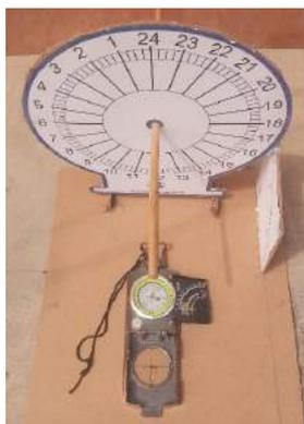
Photo 3 : Cadran solaire équatorial à double face : face fonctionnelle en hiver
