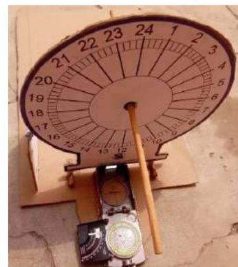
Photo 4 : Cadran solaire équatorial à double face : face non fonctionnelle en hiver
