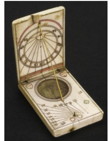
Cadran solaire diptyque du musée Galileo de Florence, avec un cadran à heures italiques en bas
