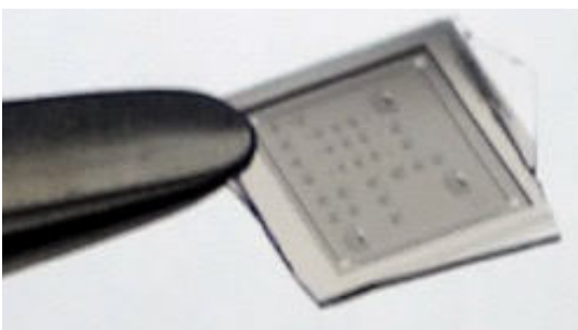
Des pincettes maintiennent la lamelle du MicroDial (sur laquelle ont été réalisés 30 tracés complets à des fins de test)
