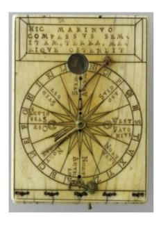
Sur le volet vertical supérieur, à l'intérieur du cadran, on aperçoit 6 points d'attache correspondant à 6 latitudes (ELEVATIO POLI): 42°, 45°, 48°, 51°, 54°, et 57°. La notice, en latin, a été inscrite par le cadranier sur cette face : Il faut faire passer le fil dans le trou qui indique la latitude du lieu et l'heure sera obtenue dans le cercle indiqué par le même nombre.
