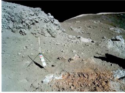
Gnomon installé à des fins scientifiques sur le sol lunaire par la mission Apollo 17 (NASA, domaine public)
