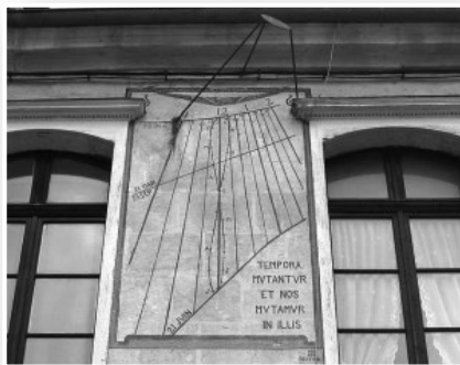
Cadran solaire avec analemme de correction de l'heure pour midi solaire à Pontarlier. (Arnaud 25, Wikimedia Commons)
