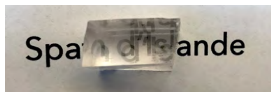
FIGURE 12 – La biréfringence du spath d'Islande : une double réfraction se constate, le texte apparaissant en double.
